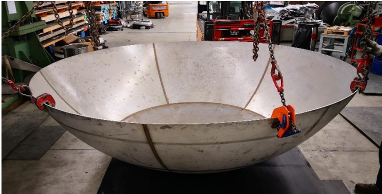
Fondo Emisferico Inox Ribassato D=3150 spessore 60/10
