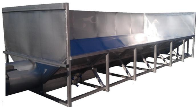
Vasche Ricevimento Uve realizzate in acciaio Inox AISI 304 rinforzate complete di tramoggia a V, coclea D=300 o D=400, Motoriduttore o Motovariatore, protezione antinfortunistica.
