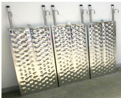
Piastra di scambio termico CALDO/FREDDO interna elettrolucidata con attacchi da 1/2" e portagomma completa di ganci, per fermentazioni a cielo aperto
