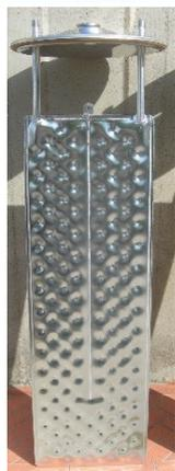
Piastra di scambio termico CALDO/FREDDO interna elettrolucidata con attacchi da 1/2" e portagomma
