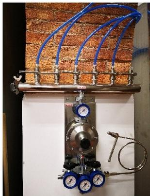
Distributore per colmatatura/saturazione con Azoto/Argon
