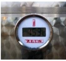
Indicatore di temperatura Inox Digitale con pozzetto stagno
