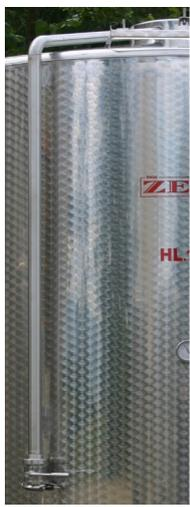
Tubazione di carico o ricircolo DN40-50-60-80 con attacco interno al chiusino e valvola a sfera pesante
