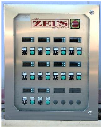
Quadri di controllo temperature con visualizzazione per singolo serbatoio
