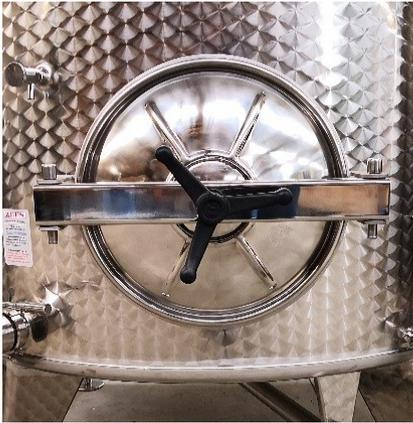
Portella inferiore pesante CILINDRICA D=420 ad apertura esterna con accessori
