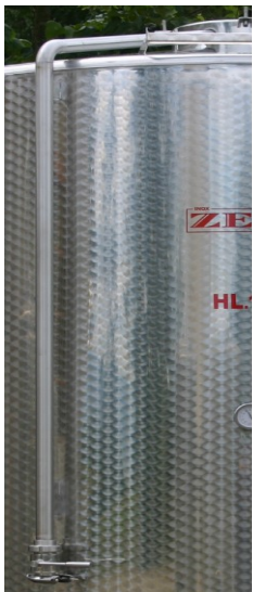
Tubazione di carico o ricircolo DN40-50-60-80 con attacco interno al chiusino e valvola a sfera tipo pesante
