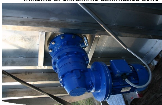
Sistema di estrazione automatica delle vinacce con portella a scarico agevolato
