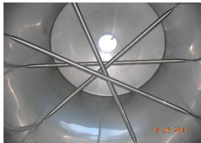
Barre in Acciaio Inox AISI 304-316L per DELESTAGES smontabili.
