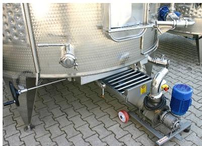
**PORTELLA INFERIORE DI SCARICO SU POMPE VOLUMETRICHE**
